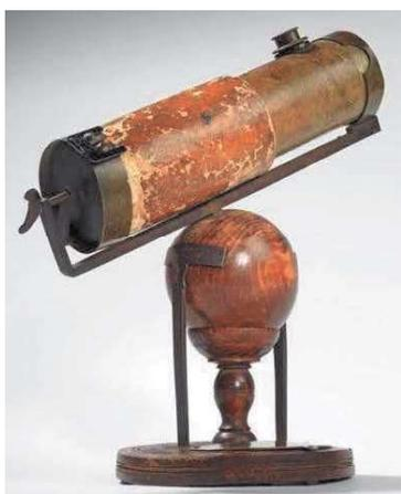
Figura 20. Réplica del telescopio reflector de Isaac Newton
