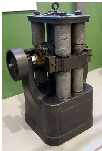
Figura 4. Generador de corriente continua de Gramme que se exhibió en la Exposición Mundial de 1873 en Viena.
