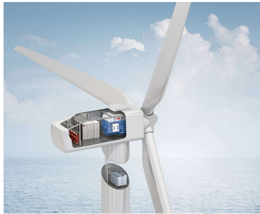
Figura 33. Información suministrada por la empresa ABB sobre su convertidor PCS6000 MV. Este convertidor puede manejar hasta 12 MW de potencia, con tensiones de entrada y salida de hasta 3,4 kV. Su rendimiento alcanza el 98%, lo que da una idea de lo madura que está esta tecnología. Los semiconductores de potencia usados en este caso son IGCTs ( Integrated Gate-Commutated Thyristors ), una versión evolucionada de tiristor de alta potencia que se puede apagar por su terminal de puerta. a) Fotografía del equipo suministrada por el fabricante. b) Instalación del mismo en un generador eólico marino.
