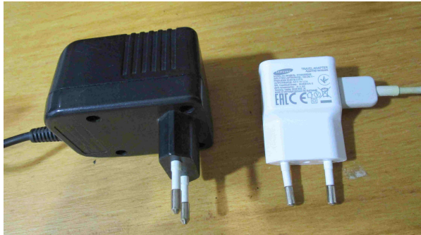
Figura 20. Cargadores de batería de teléfonos móviles. El de la izquierda es un cargador con regulador lineal, que se alimenta de una red europea (exclusivamente) de entre 230 y 240 V de tensión alterna, siendo capaz de manejar a su salida una potencia de 4,8 W y pesando 252 gramos, lo que significa una densidad gravimétrica de potencia de 19 mW/g. El cargador de la derecha es un cargador con convertidor conmutado, que puede alimentarse con tensiones alternas comprendidas entre 100 y 240 V (tensión universal) y entrega 5 W a la salida, pesando 34 gramos, lo que significa una densidad gravimétrica de potencia de 147 mW/g (más de 7 veces mayor que en el caso anterior). El cargador de la izquierda no podría usarse en países como Estados Unidos, Canadá, México, Colombia, Venezuela, Japón o Taiwán, mientras que el de la derecha se puede utilizar en todo el mundo.
