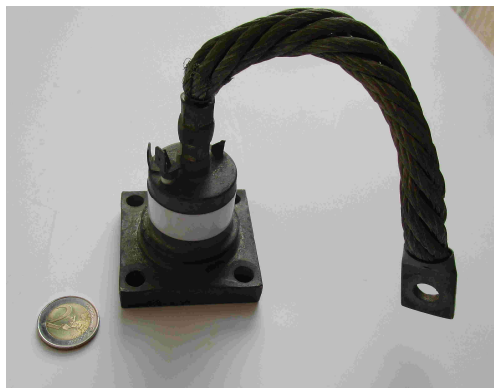
Figura 17. Antiguo tiristor SCR de alta potencia. En el ejemplar disponible, no se aprecian sus referencias. Este dispositivo probablemente data de principios de los años 80.
