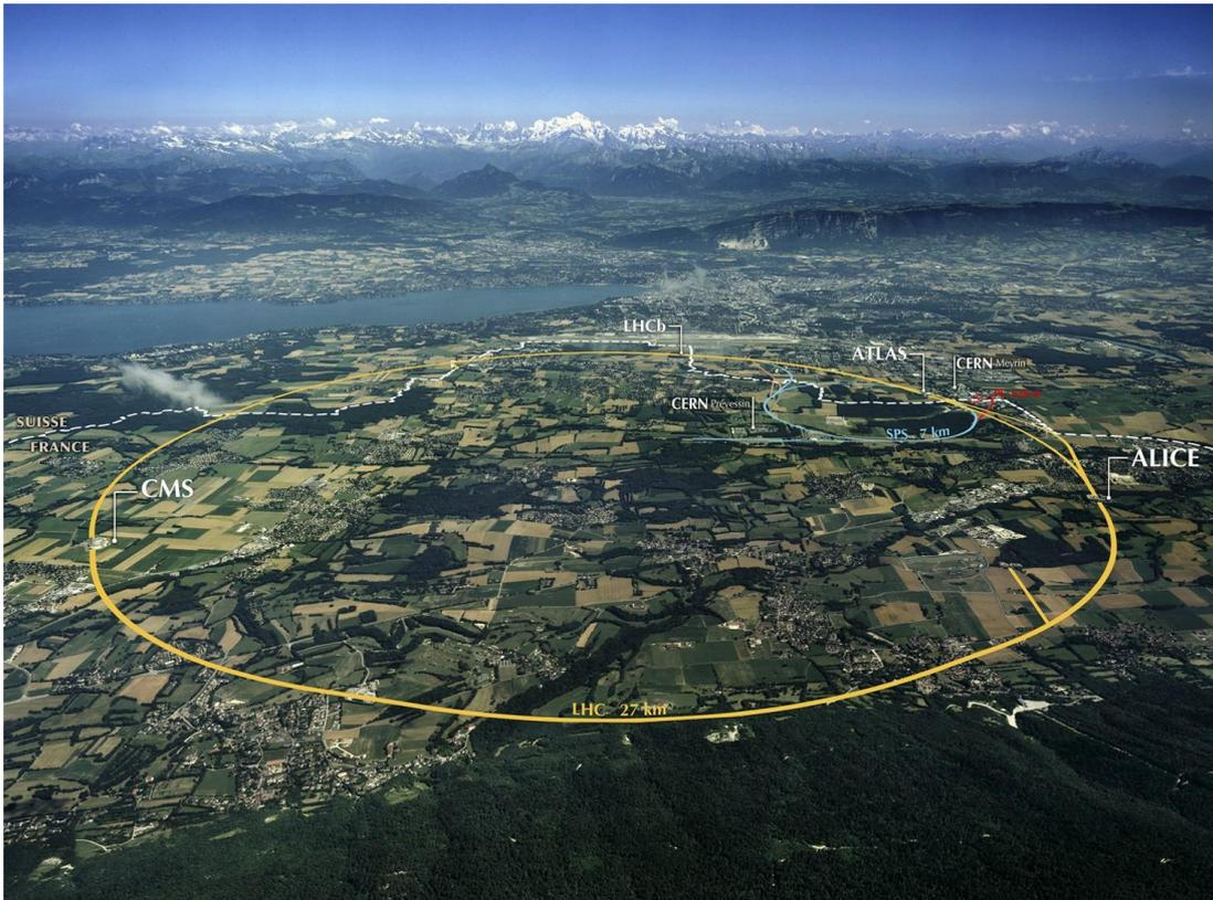
Figura 23: Foto aérea de la región en la frontera entre Francia y Suiza donde se sitúa el túnel del LHC. Se observa superpuesta la posición del SPS, el inyector principal del LHC, y los 4 detectores principales.
