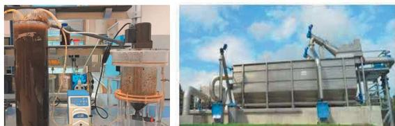
Figura 43. Lodos activos en laboratorio, y planta integrada modular
