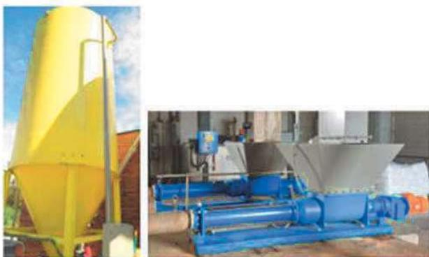
Figura 42. Depósito y bomba para fangos
