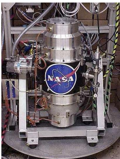
Figura 21. Módulo de almacenamiento de energía en forma de energía cinética de rotación, desarrollado por la NASA.
