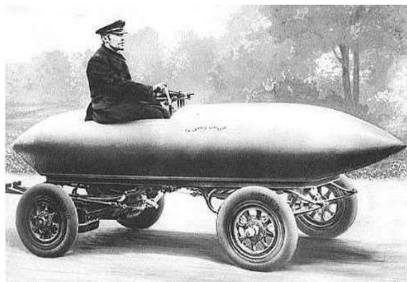
Figura 30. Foto histórica de "La Jamais Contente", primer automóvil en superar los 100 km/h. Se trataba de un vehículo eléctrico, construido y conducido por el belga Camille Jenatzy, apodado "El Diablo Rojo", por su barba pelirroja.
