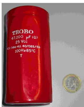
Figura 22. Condensador electrolítico convencional. Su densidad de energía volumétrica es de 75 julios por litro. La de la gasolina es de 35 millones de julios por litro.
