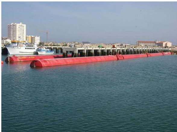
Figura 19. Un ejemplo de energía "nueva" es la energía mecánica obtenida como consecuencia del oleaje. Esta energía puede ser transformada en eléctrica con un equipo tipo "Penalis", como el mostrado en esta figura. La foto corresponde a su fase de pruebas en el año 2007, en el Puerto de Peniche, en Portugal.
