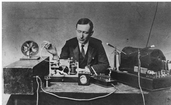
Figura 37. Fotografía de Guglielmo Marconi tomada en 1901. A la izquierda se aprecia el receptor telegráfico, con los mecanismos propios del telegrafo de Morse para dejar el mensaje impreso en una cinta de papel. A la derecha se aprecia un carrete de Ruhmkorff, que es en cargado de generar las descargas eléctricas (chispas) propias de este tipo de transmisores.
