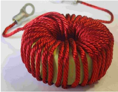
Figura 24. Bobina toroidal con núcleo de "polvo de hierro". Este tipo de dispositivo se utiliza en electrónica de potencia para almacenar energía eléctrica en forma de campo magnético. Sólo es efectiva almacenando energía en tiempos tan cortos como algunas decenas de microsegundos.
